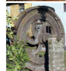
Turbine en fonte à sept branches d'un diamètre de 2,4 m avec son injecteur interne centrifuge • Maison Bergès à Lancey.
