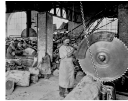
(G) Sciage des billes de bois - (D) L'atelier de défibrage.
